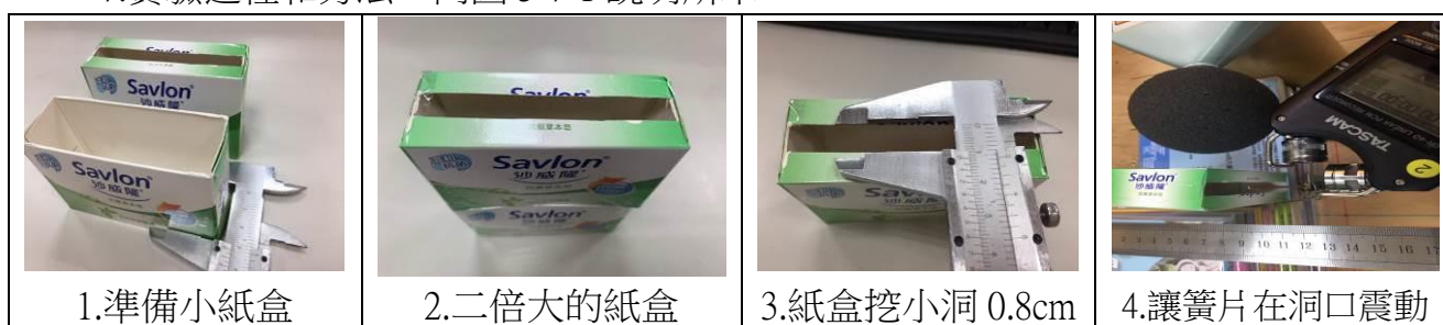
圖 5-7-1 模擬口簧琴音箱實驗過程說明圖
